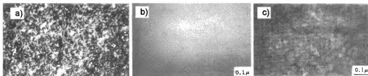
Rys. 3.13. Zdjęcia z transmisyjnego mikroskopu elektronowego powierzchni stali nierdzewnej implantowanej jonami krzemu z różnymi dawkami; a) 5 \times 10^{16} at./cm 2 , b) 1 \times 10^{17} at./cm 2 , c) 2 \times 10^{17} at./cm 2 .
