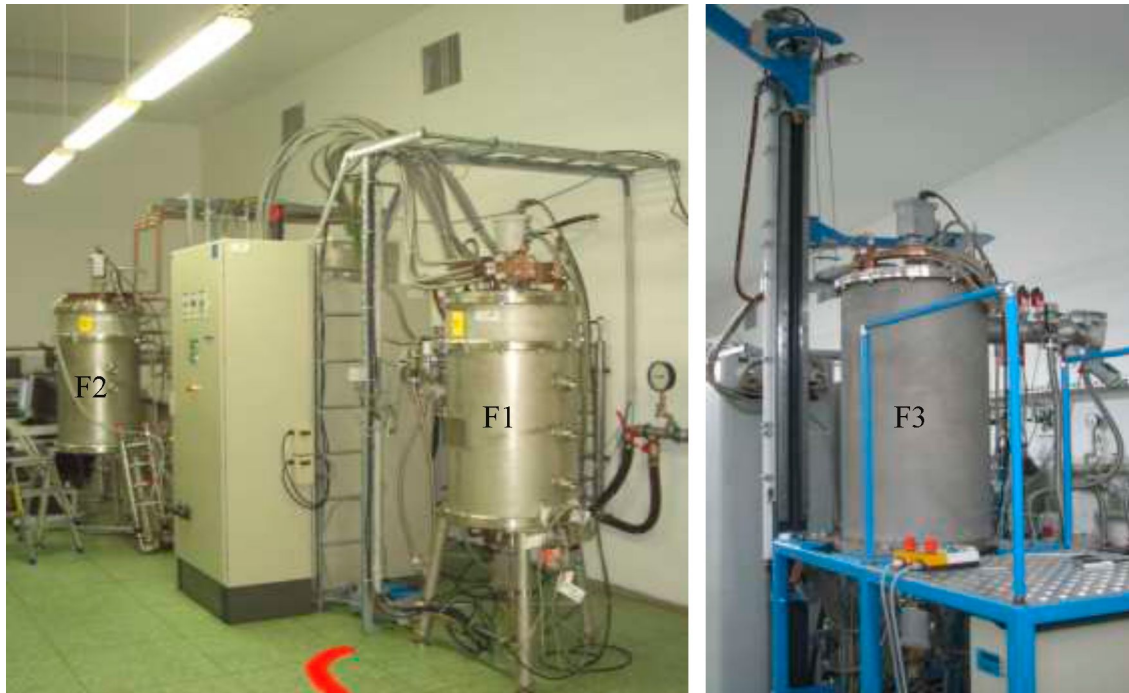
Rys. 15. Stanowisko do monokryształizacji węgla krzemu zlokalizowane w Laboratorium im. Jana Czochralskiego w ITME.
