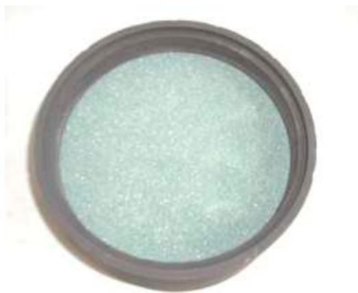
Rys. 25. Świeży materiał wsadowy SiC umieszczony w grafitowym tyglu.
