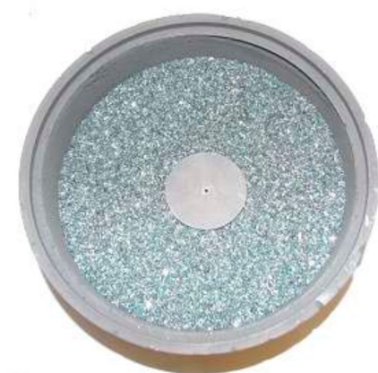
Rys. 91. Tygiel z materiałem wsadowym SiC, w którym został umieszczony pojemnik z domieszką CeO_2 .
