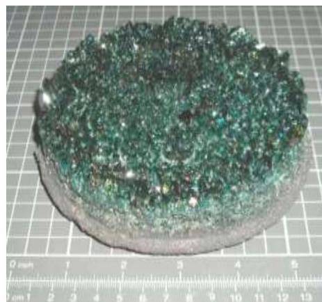
Rys. 26. Wygrzany materiał wsadowy SiC po wyjęciu z tygla.
