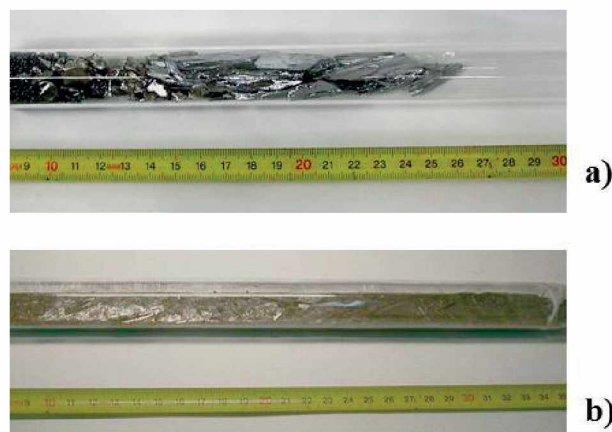
Rys. 4. Widok ampule kwarcowej z wsadem: a) – po załadunku bizmutu i selenku, próżnia na poziomie 2 \times 10^{-5} Tr, masa wsadu \sim 140 g; b) – po poziomym procesie syntezy: topienie w \sim 710 °C, homogenizacja wsadu w \sim 820 °C ze stopniowym studzeniem.
