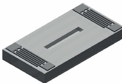
Rys. 3. Mikrokanal wycięty w warstwie materiału piezoelektrycznego ( \text{LiNbO}_3 ) [19].
