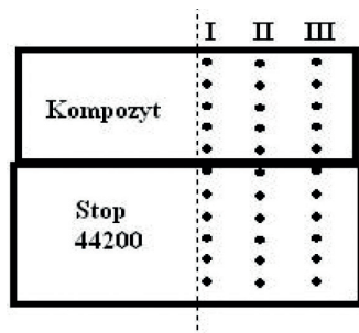
Rys. 12. Schemat pomiarów twardości w złączach stop 44200 - kompozyt.
