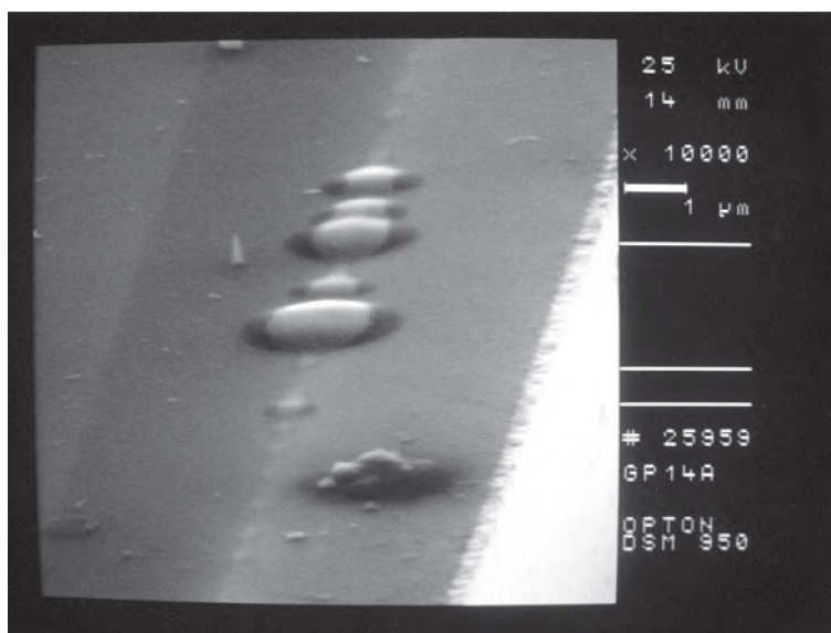
Rys. 8. Fotografia SEM lustra DL po degradacji katastroficznej (dokumentacja ITME). Fig. 8. SEM microphotograph of catastrophically degraded LD's facet (ITME files).
