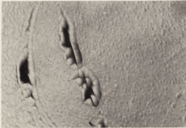
Fot. 11. Wady powierzchni wynikające z niewłaściwego dobrania warunków termicznych procesu (pow. \times 190 )
