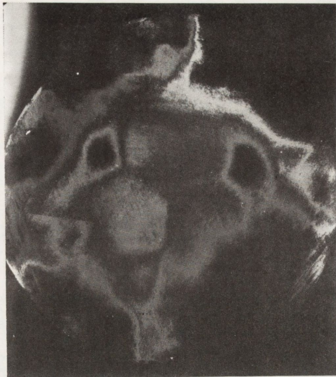
Rys. 3. Przykładowy topogram rentgenowski płytki GaP ujawniający trójsektorową strukturę odkształceń wewnątrz kryształu
