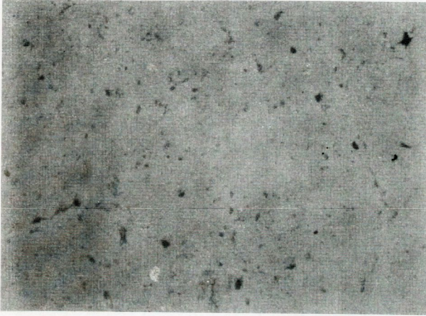
Rys. 1. Wolfram z 1% dodatkiem Ni po sprasowaniu izostatycznym na gorąco pod ciśnieniem 125 MPa w temperaturze 1620°C. Szlif nietrawiony, pow. 200x
