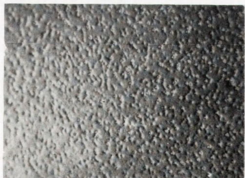
Rys. 3. Obrazy defektów strukturalnych w bezdyslokacyjnym monokryształe GaAs:Si a - obraz w mikroskopie optycznym z kontrastem Nomarskiego, po selektywnym trawieniu chemicznym, b, c - obrazy katodoluminescencyjne, naniesiona skala odpowiada 100 \mu\text{m}
