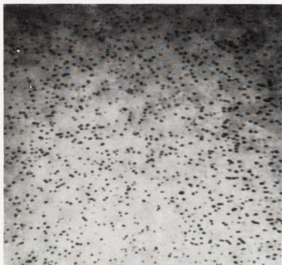
Rys. 3. Obrazy defektów strukturalnych w bezdyslokacyjnym monokryształe GaAs:Si a - obraz w mikroskopie optycznym z kontrastem Nomarskiego, po selektywnym trawieniu chemicznym, b, c - obrazy katodoluminescencyjne, naniesiona skala odpowiada 100 \mu\text{m}
