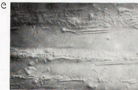
Rys. 2. Przykłady obrazów defektów strukturalnych w płytce z monokryształu SI GaAs:In a,b,c - obrazy CL, d,e,f. - obrazy w mikroskopie optycznym po selektywnym trawieniu w roztworze AB /a,b,d,e - obszary brzegowe płytki, c,f - środkowa część płytki. Naniesione skale odpowiadają 100 \mu\text{m} /
