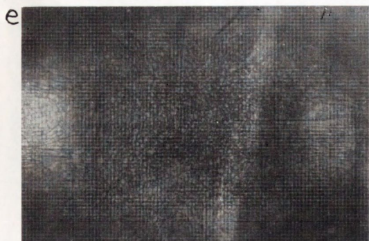
Rys. 2. Topogramy próbek wyciętych z dolnych części półizolacyjnych monokryształów GaAs a - topogram dwukrystaliczny próbki wyciętej z tego samego monokryształu, co próbka przedstawiona na rys. 1a; b,c,d - seria topogramów dwukrystalicznych próbki z dolnej części monokryształu niedomieszkowanego o dużej średnicy; e - topogram Langa próbki przedstawionej na rys. 2. b,c,d; f - topogram Langa próbki domieszkowanej chromem
