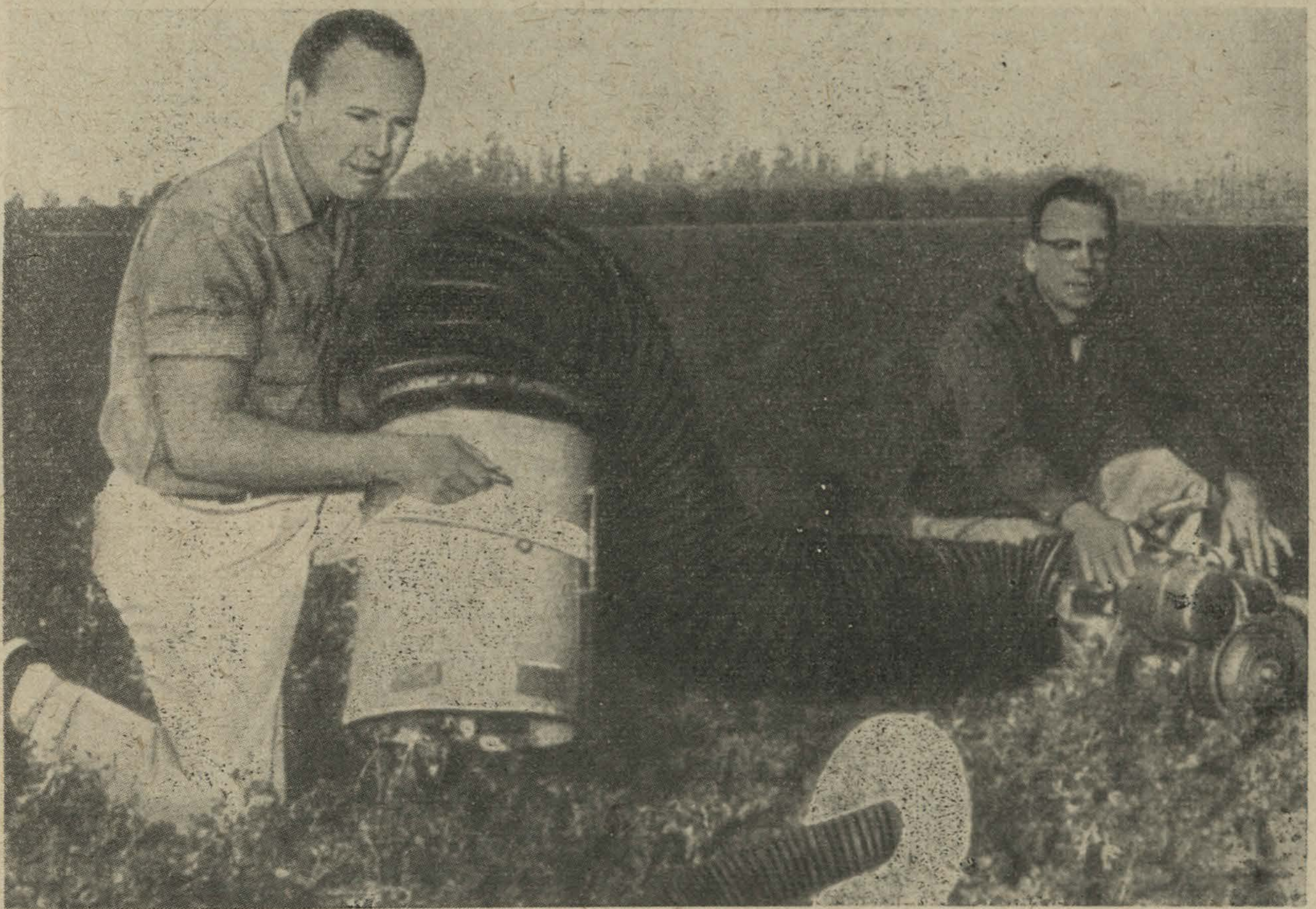
Fig. 1. Typ ssawki o dużej średnicy otworu wpustowego (wg Dietrick, Schlinger i Bosch 1959)
