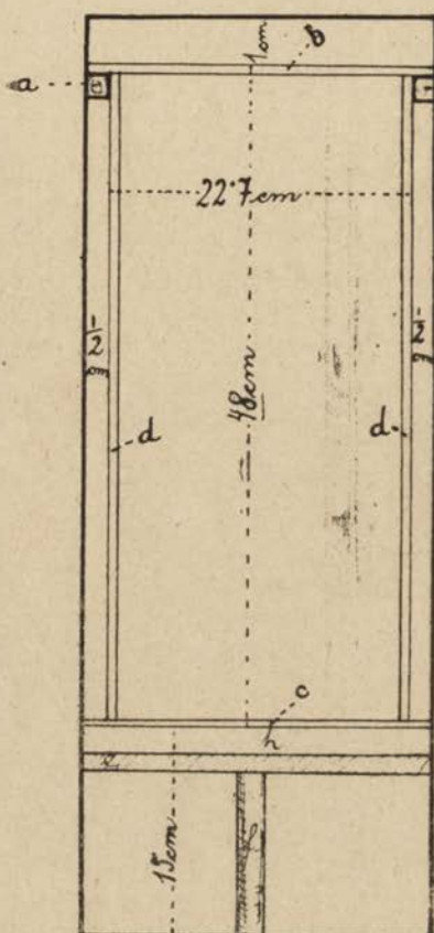
Ryc. 66. przedstawia ramkę wiszącą, a zatem prozków na dole, ani bocznych listewek trójkątnych nie trzeba; f = słupek, podpierający podsuwkę e; h = 1 cm. miejsce pod ramkami; a a = 5 mm. kwadratowe listeweczki, na których ramki wiszą wąsami a a; na dole także są takie wypusty czyli wąsy ramek; b = 1 cm. przestrzeń między powalą a ramkami; A = górna i dolna listewka na ramki ma mieć wystające wąsy zaokrąglone, by łatwo w ul wchodziła.
