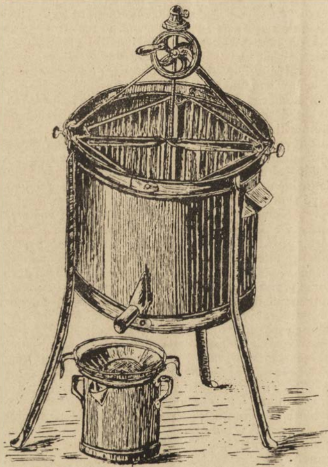
Ryc. 46. Miodarka poruszająca się b. cicho, na której można wytrząsać miód z ramek wszelkich typów uli.
